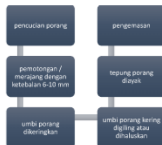
Gambar 1. Alur Proses Pembuatan Tepung Porang
