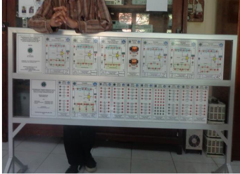
Gambar 1. Alat peraga pembangkit sinyal yang dikemas dalam satu rak, terdiri atas: oscillator Phase shift RC , Wien Bridge [9], Colpitts , Hartley , Astable Multivibrator [3] (Doc. Syifaul Fuada)
